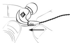
ケーブルを取り外す際は、イヤホン本体とケーブルのプラグ部分をしっかりと持ち捻らずにまっすぐに引き抜いて下さい。捻ったり無理な方向へ力を加えると破損の原因となります。
